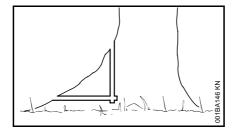
große Wurzelanläufe beisägen: zuerst den größten Wurzelanlauf – erst senkrecht, dann waagerecht einsägen – nur bei gesundem Holz
