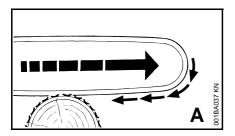
Wenn beim Sägen mit der Unterseite der Führungsschiene – Vorhandschnitt – die Sägekette klemmt oder auf einen festen Gegenstand im Holz trifft, kann die Motorsäge ruckartig zum Stamm gezogen werden – zur Vermeidung Krallenanschlag immer sicher ansetzen.
