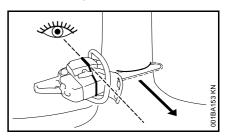
Mit Hilfe der Fällleiste an Haube und Lüfter-Gehäuse der Motorsäge kann beim Schneiden des Fallkerbes die Fällrichtung kontrolliert werden.
