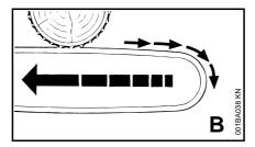
Wenn beim Sägen mit der Oberseite der Führungsschiene – Rückhandschnitt – die Sägekette klemmt oder auf einen festen Gegenstand im Holz trifft, kann die Motorsäge in Richtung Benutzer zurück gestoßen werden – zur Vermeidung:
